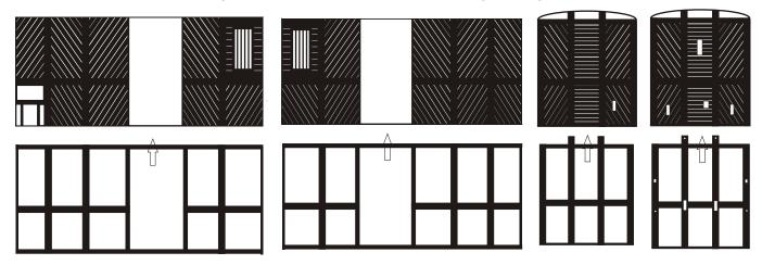
2-Souder les deux portes par l'intérieur, sur les deux faces fermetures des portes comme sur le dessin.
