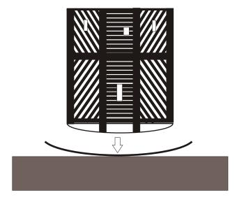
10- Positionner le lanternaux , placez le au bord avant et souder le sur le toit, dans l'axe.
